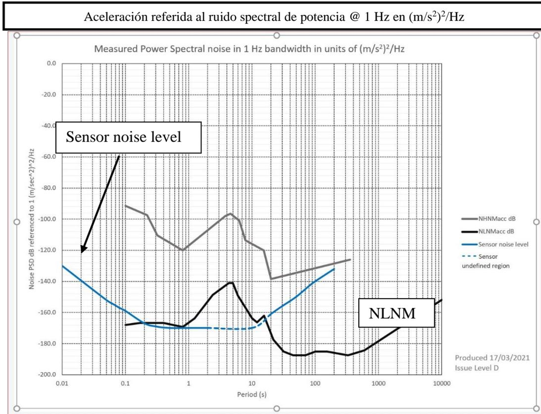
La línea azul continua es la densidad de ruido espectral de potencia del sensor en todo el espectro sísmico. El nivel de ruido del sensor cruza el modelo de bajo ruido de 8 Hz a 14 segundos.
